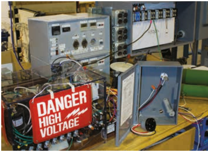
Figura 3. Configuración de las pruebas para la norma NEMA 410 de Intermatic
